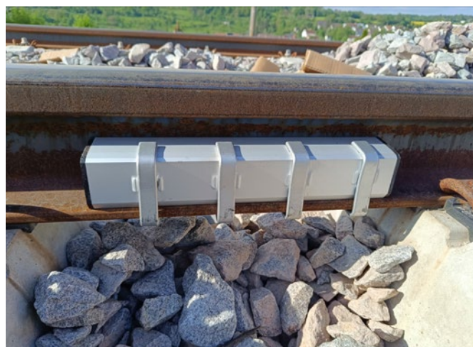
Bild 2: Die Montage mit Klammern gewährleistet eine sichere Verbindung mit der Schiene
